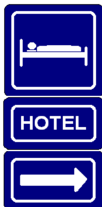
Figura 9. Rótulo D9-9 para hotel en la carretera que provee acceso con placa educacional (HOTEL) y placa auxiliar de dirección.
