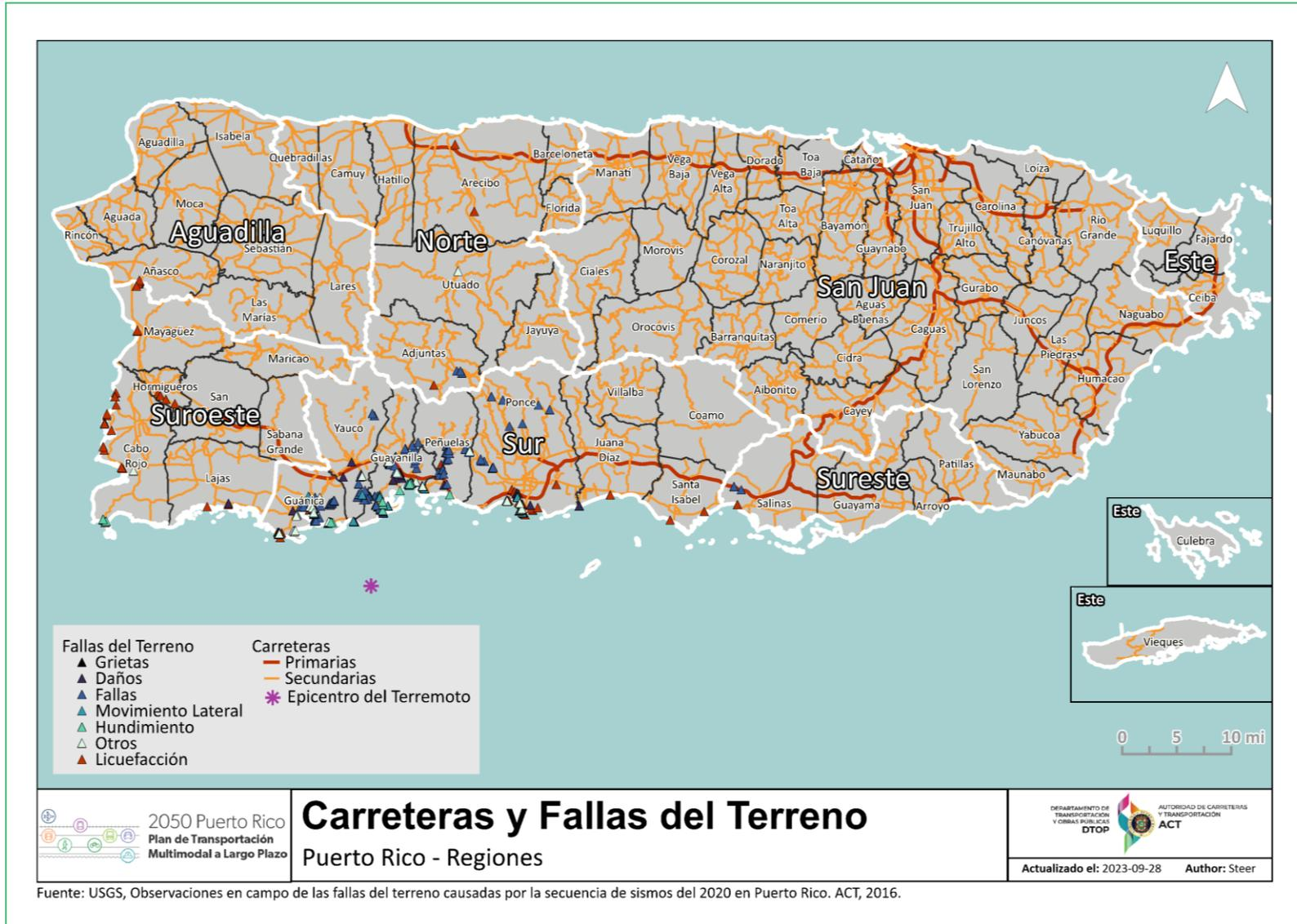
Figura 6.5: Infraestructura con Fallas del Terreno en el Año 2020
